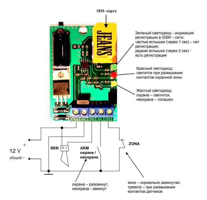
К выходу SRN подключается пьезосирена с током потребления до 300 мА. Для использования более мощной сирены необходимо вместо сирены подключить реле на 12 вольт, а его нормально разомкнутыми контактами подавать питание на сирену непосредственно от источника питания 12V.
